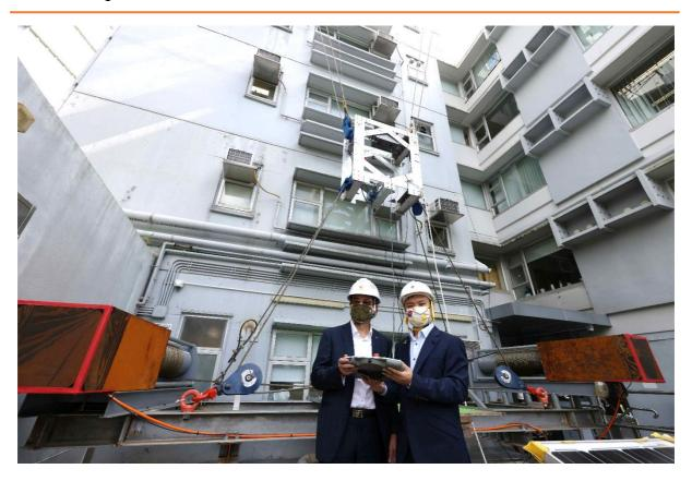
由俊和與中大工程學院研究團隊合作研發的「外牆高空工作線控機械人」,為本港目前首個可模仿工人於外牆以雨刮抹窗,及控制滾筒塗漆的機械系統。去年11月16日,俊和建築控股主席李家粦測量師接受各大傳媒的訪問時表示,期望研究項目除了助解決勞動力不足問題外,更能減低前線工人在高空工作的風險,達致「工地零意外」的目標。
